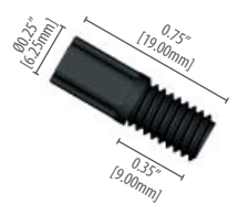
008NF32-YC6B Nut for 1/8" OD tubing M6, black
