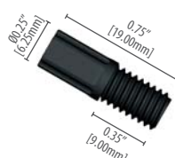
008NF16-YC6B Nut for 1/16" OD tubing M6, black
